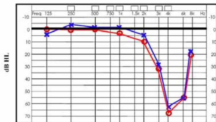
Figur 1.3 Uttalad diskantskada orsakad av buller där audiogrammet visar en nedsättning till 70 dB i diskantområdet med maximum vid 4 kHz medan lågfrekvensområdet uppvisar helt normala hörrösklar.
