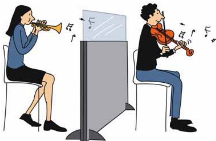
Figur 8.8 I ett orkesterdike kan ogenomskinliga skärmar användas. För att möjliggöra utsikt till dirigenten kan den övre delen göras transparent.
