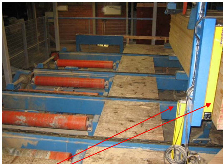
Ljusbommarna som skyddar riskområdet vid paketläggare respektive transport av paket till rullbana
