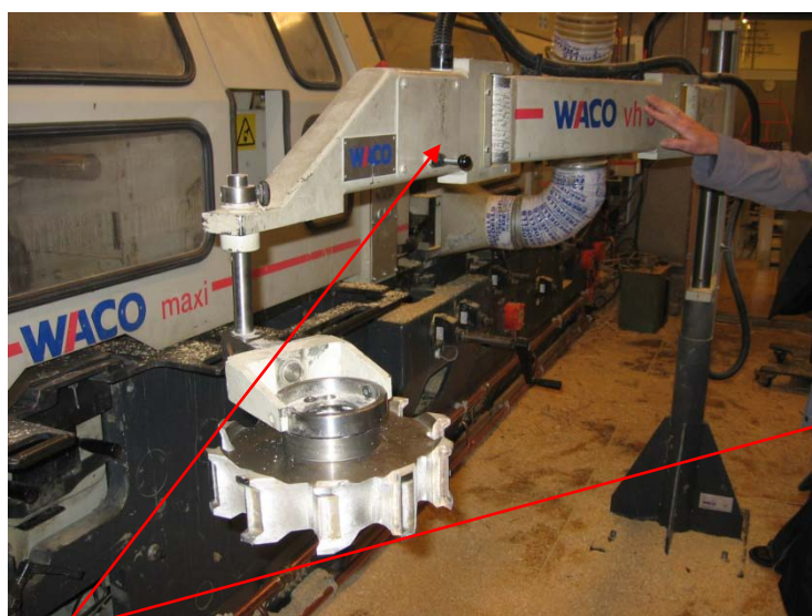
Verktögslyft för att lyfta tunga hyvelkutterar (vikt upp till 50 kg) till och från flerspindlig hyvel. Anordningen användes också i kombination med exempelvis verktygsvagn för att underlätta transport av verktyg till och från sliprummet
