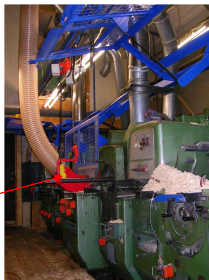
Verktögslyft för att lyfta tunga hyvelkutterar (vikt upp till 50 kg) till och från flerspindlig hyvel. Anordningen användes också i kombination med exempelvis verktygsvagn för att underlätta transport av verktyg till och från sliprummet
